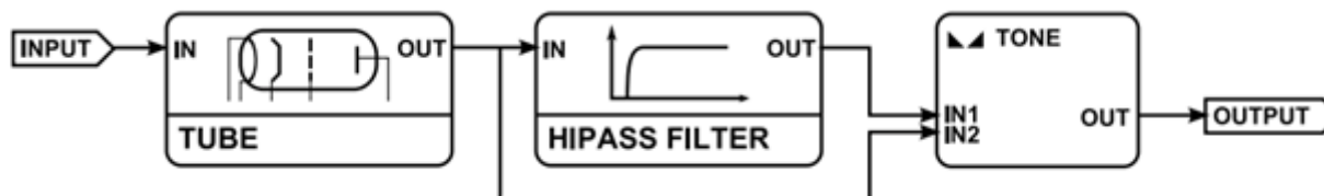
Diagramm des Signalflusses durch die Röhren-Verzerrung
