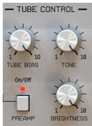
Section de distorsion à lampe.
